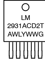
D2PAK D2T SUFFIX CASE 936A
